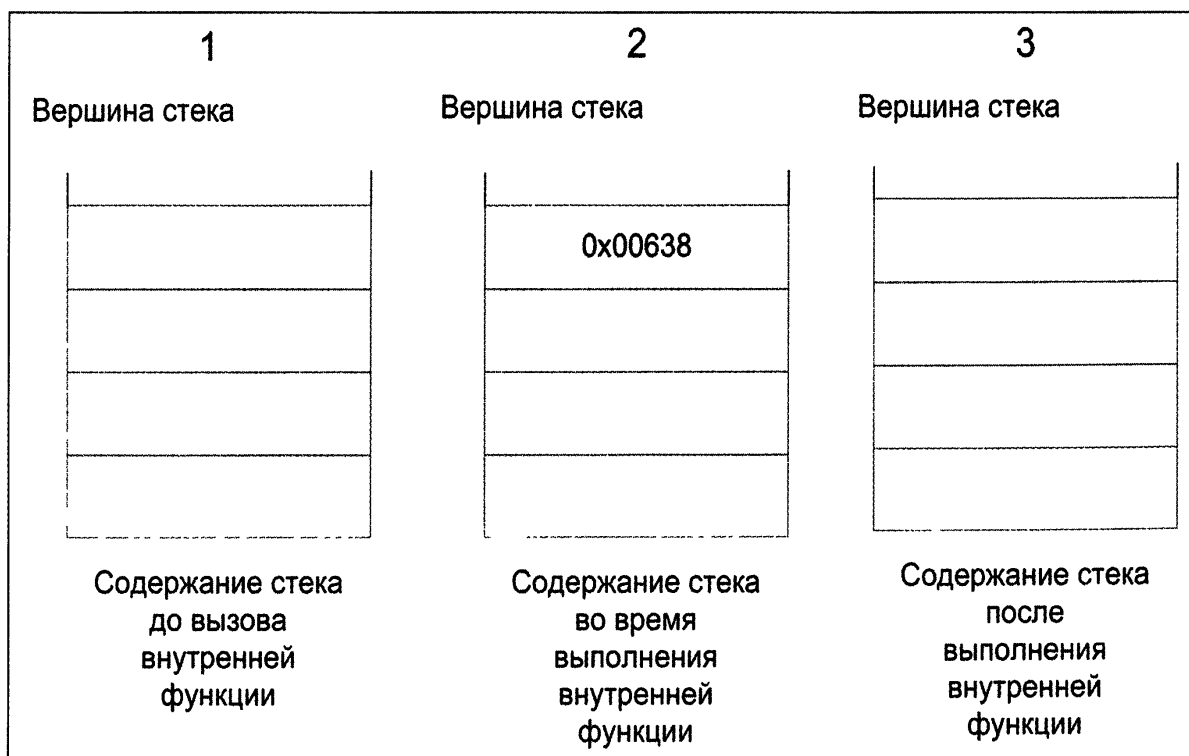
Содержание стека во время функционирования программы
