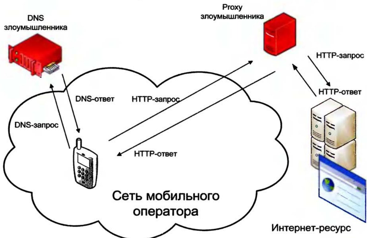
Схема функционирования доступа в Интернет с мобильного телефона после атаки с подменной DNS
