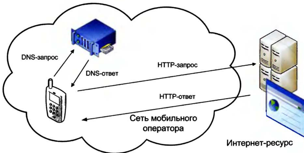
Схема функционирования DNS-сервера в сети мобильного оператора
